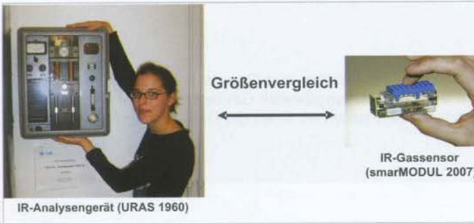
Bild 3: Größenvergleich eines IR-Gasanalyseräts in klassischer Bauweise im Vergleich mit einem miniaturisierten IR-Gassensor
