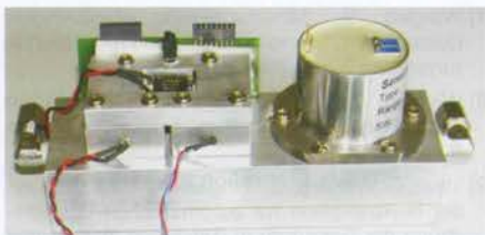
Bild 6: Sensorsystem zur Bestimmung des Brennwertes von Erdgas mit 2 IR-Gassensoren (HC und CO 2 ) sowie eines Wärmeleitfähigkeitssensors (WLD) [4]
