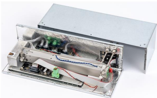
Beheizte Küvette (55°C) mit Edelstahlverrohrung in einer Thermobox
