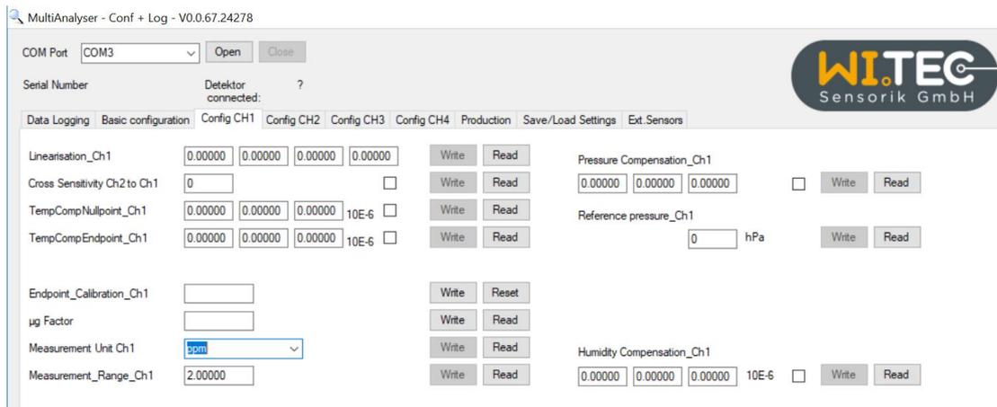
Abb. 15: Dritte Ebene (Config CH1.....CH4) der Bediensoftware MARS-Tool
