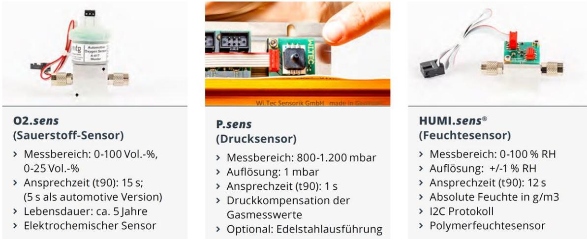
Abb. 10: Optionale Sensoren zur Sauerstoff-, Druck und Feuchtemessung
