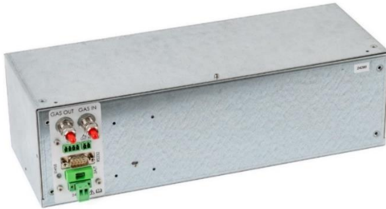
Abb. 6: Thermobox mit integriertem SPECTRO.sens-Aufbau. Von außen erkennbar sind die Gasanschlüsse (4/6-Schlauch), Eingang der Spannungsversorgung (24VDC) und Datenkommunikation (RS232- und CAN-Interface).
